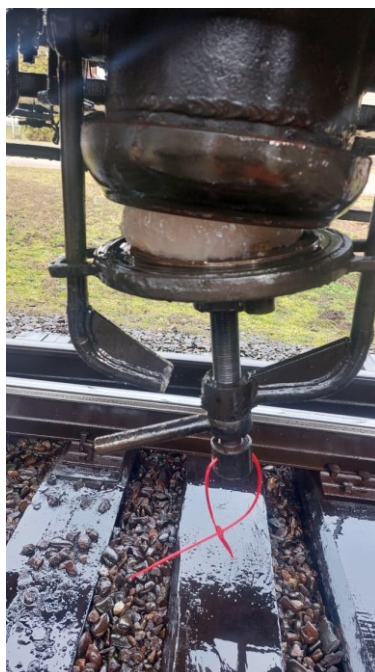
Фото 1 – Ледяная пробка в нижнем сливном приборе вагона № 73125379.
